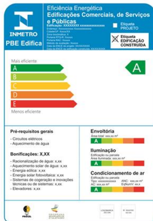
Figura 30 – Exemplo de ENCE de Edificações para etapa de edificação construída Fonte: adaptado de MMA (2015a)
